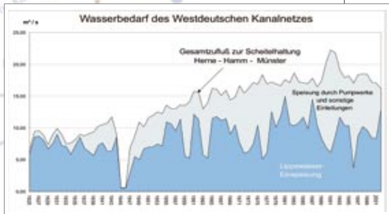
Gesamtzufluss zur Scheitelhaltung Herne-Hamm-Münster
